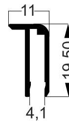
DES-884 0,977Kg/Barra 6m ESPESSURA = 1.2mm
